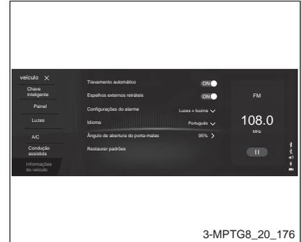
O rebatimento do espelho retrovisor externo pode ser ajustado através do sistema multimídia.
